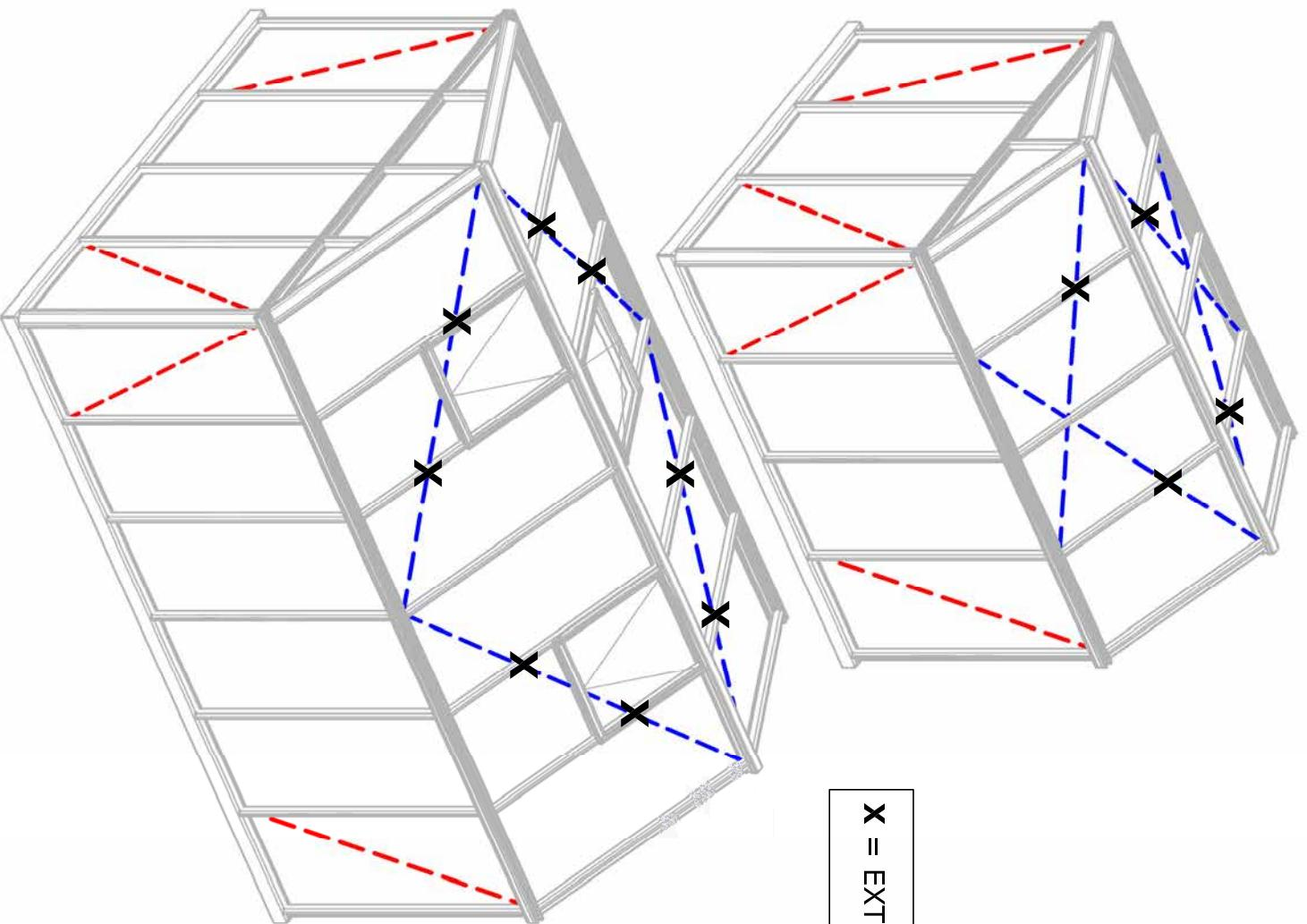
**X = EXTRA FIXING / EXTRA BEFESTIGUNG / ATTACH EXTRA**
